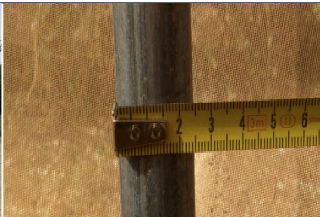
Structure en tube galva de diamètre inférieur à 32
